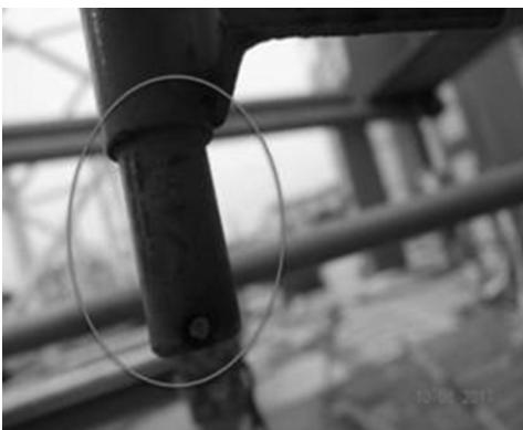
图3-9 换步销操作滑杆安装支座
