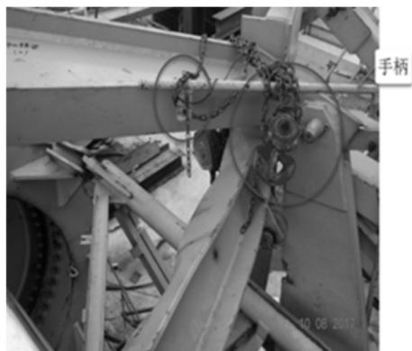
图3-10 右侧顶升销轴辅助连杆装置
