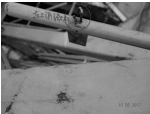
图3-11 左顶升销轴操作杆的滑杆插孔
