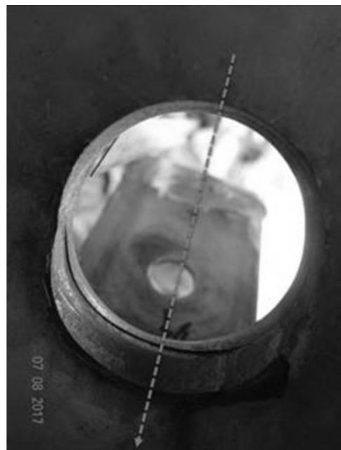
图 3-4 右顶升销轴孔边塑性变形
