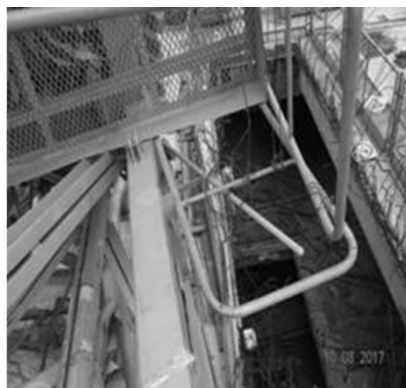
图 3-12 左侧换步销轴操作杆的滑杆插孔
