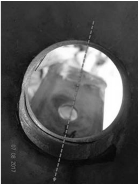
图 3-4 右顶升销轴孔边塑性变形
