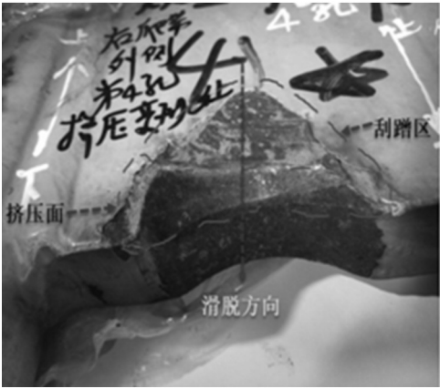
图 3-5 右顶升爬梯第四孔形貌
